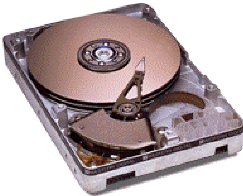
Рисунок 1. Современный винчестер со снятой крышкой.
